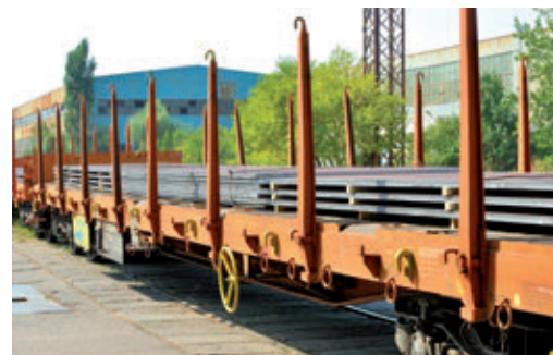
Laddove possibile, ArcelorMittal consegna le lamiere da treno quarto destinate al cantiere con trasporto ferroviario.
