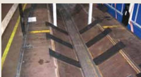
Obr. č. 2.19 Protišmykové podložky v „normálnom“ prívese s drážkami
