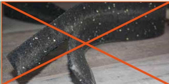
Obr. č. 2.18 Príklad poškodenéj protišmykovej podložky (roztrhaná)
