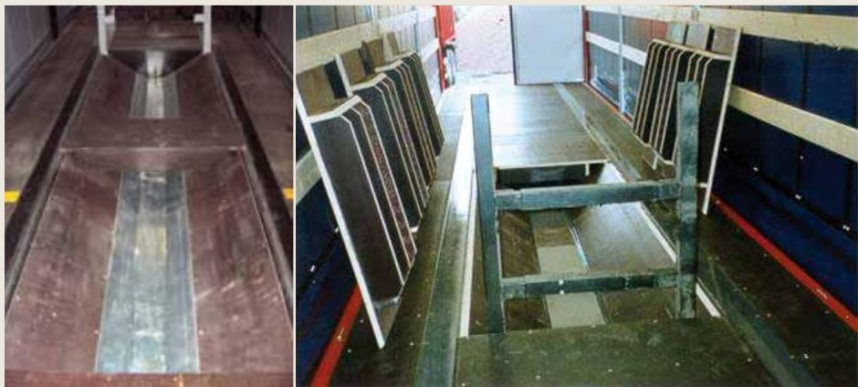
Obr. č. 1.1 a č. 1.2 – Fotografia usporiadania bežného prívesu vybaveného drážkami a podpornou konštrukciou
