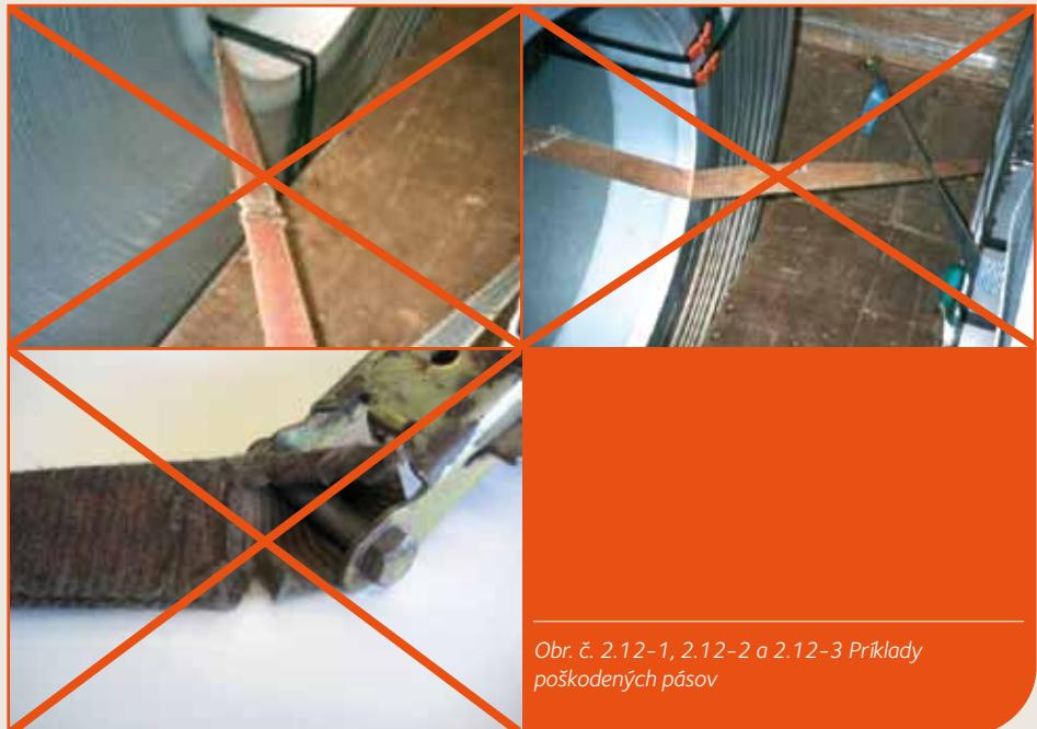
Obr. č. 2.12-1, 2.12-2 a 2.12-3 Príklady poškodených pásov
