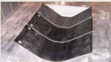
Obr. č. 2.20 Protišmykové podložky pre vyklápač
