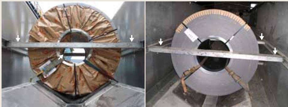
Obr. č. 1.9 Najlepšia podporná konštrukcia pred a za zvitkom bez uväzovacích prostriedkov
