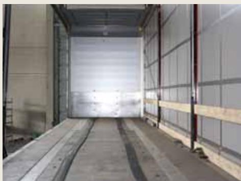
Obr. č 1.10 – Príklad prívesu so založenými krytmi drážok.
