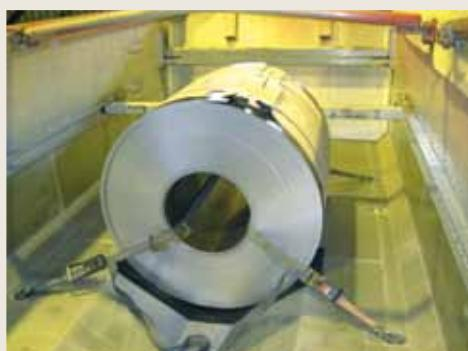
Obr. č. 1.7 Podporná konštrukcia pred zvitkom s uväzovacími prostriedkami;
