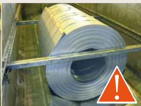
Obr. č. 1.8 Podporná konštrukcia pred a za zvitkom bez uväzovacích prostriedkov
