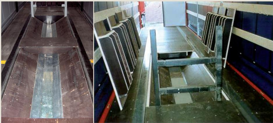
Sl. 1.1 i 1.2 – Fotografija normalnog rasporeda priklice opremljene žlebovima i potpornom konstrukcijom
