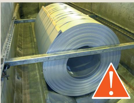
Sl. 1.8 Potporna konstrukcija ispred i iza kotura bez vezova.
