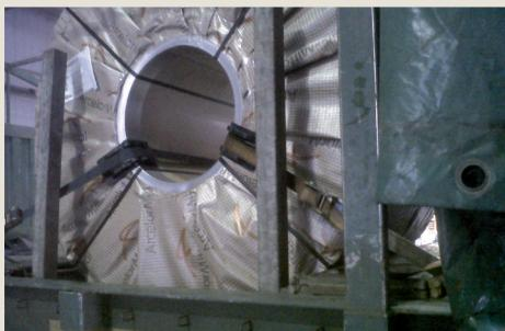
Sl. 1.13: Slučaj zamenjivog kamionskog sanduka opremljenog za prijem kotura sa osovinom poprečnom u odnosu na smer vožnje; obezbeđivanje je izvršeno sa dva remena i pomoću četiri ugaona štitnika. Na obe strane mora da se postavi par potpornih stubova.
