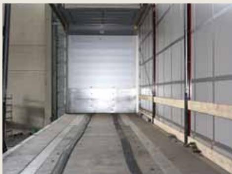
Fig. 1.10 – Exemplu de remorcă cu alveole acoperite
