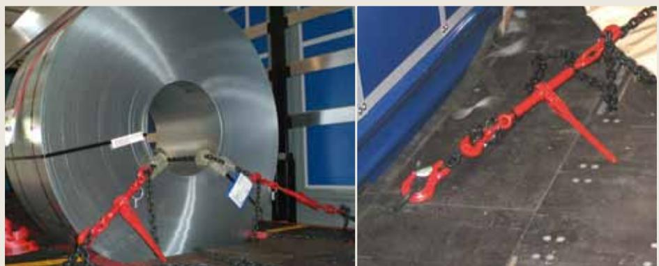
Fig. 2.16-1 și 2.16-2 Mecanism cu clichet în stare bună
