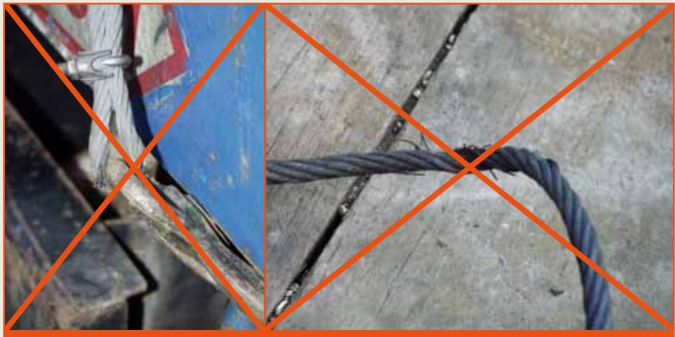
Fig. 2.15-1, 2.15-2 Cabluri în stare inadecvată
