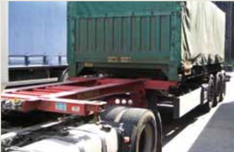
Fig. 1.12 - Corp interșanjabil încărcat pe o remorcă
