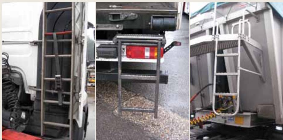
Fig. 2.24-1, 2.24-2, 2.24-3 - Exemple de scări corespunzătoare
