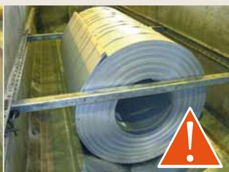
Fig. 1.8 Structura de susținere în față și în spatele ruloului fără chingi
