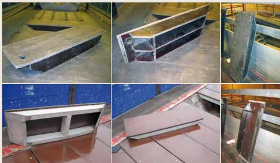
Fig. 2.09-1, 2.09-2, 2.09-3, 2.09-4, 2.09-5, 2.09-6 Exemple de capace de alveole utilizate ca distanțiere
