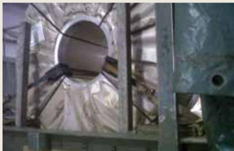
Fig. 1.13 - Corp interșanjabil echipat pentru a primi rulourile cu ax transversal pe direcția de mers; securizarea se face cu două chingi și utilizând patru colțuri de protecție. O pereche de stâlpi de susținere trebuie amplasată pe ambele părți.
