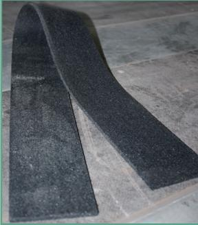
Fig. 2.17 Eksempel på en sklisikringsmatte i god stand
