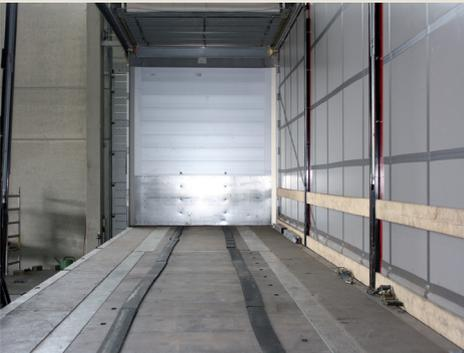
Fig. 1.10 – Eksempel på trailer med renndecksel på plass.
