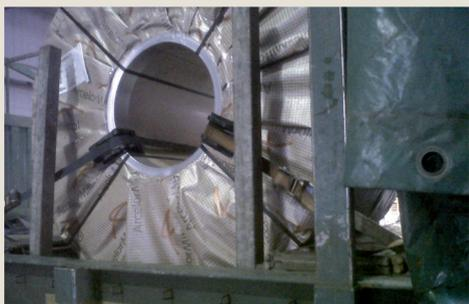
Fig. 1.13 - Vekselflak utstyrt for å ta imot ruller med aksen på tvers av kjøreretningen . Sikringen gjøres med to belter og fire hjørnebeskyttelser. Ett par med stang må plasseres på begge sider.
