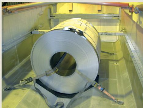
Fig. 1.7 Støttestruktur foran Rullen med bindinger
