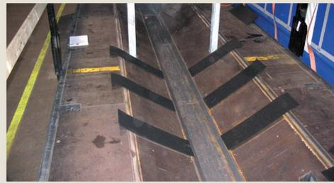
Fig. 2.19 Sklisikringsmatter i en «normal» renntrailer
