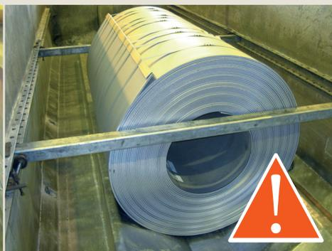
Fig. 1.8 Støttestruktur foran og bak Rullen uten bindinger
