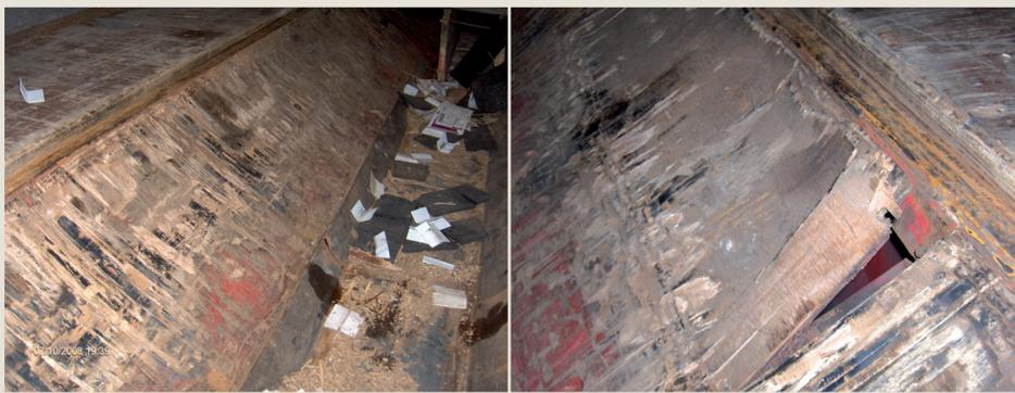
Fig. 1.3 og 1.4: Eksempler på dårlig lasteplattform [avfall, pall, ikke ren, defekter på trailerdekselet ...]
