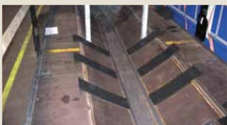
Fig. 2.19: Skridsikre måtter i en anhænger med «normal» coilbrønd
