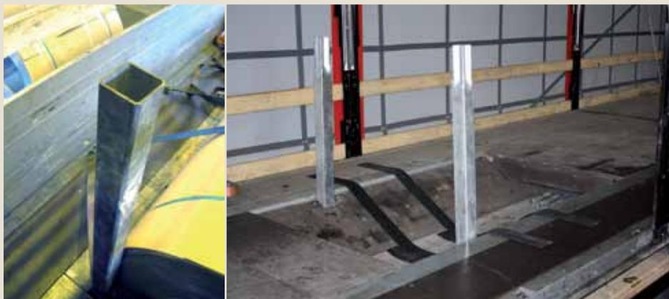
Fig 2.04 og Fig. 2.05: Kæpstokke
