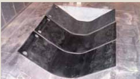
Fig. 2.20: Skridsikre måtter til tipvogn
