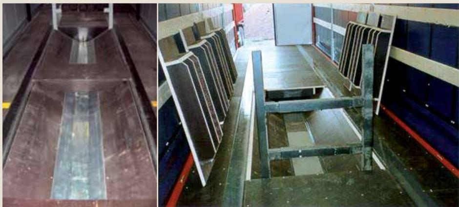
Fig. 1.1 og 1.2: Billede af en normal indrettet lastbil med coilbrønd og støttekonstruktion
