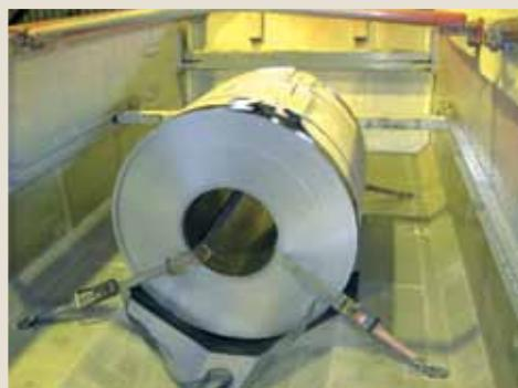
Fig. 1.7 Støttekonstruktion foran coilen med surringsbånd;
