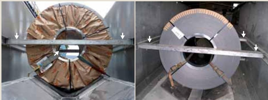
Fig. 1.9 Bedste støttekonstruktion foran og bag coilen med surringsbånd
