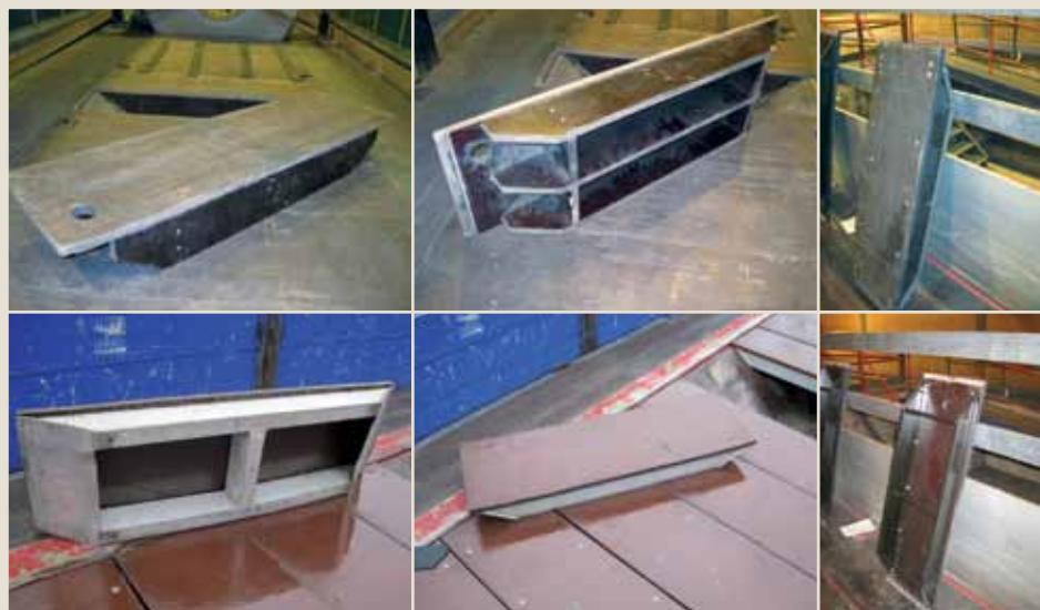
Fig. 2.09-1, 2.09-2, 2.09-3, 2.09-4, 2.09-5, 2.09-6: Eksempler på anbefaede afdækningspladetyper, hvis de anvendes som afstandsholdere
