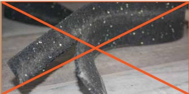
Fig 2.18: Eksempel på en dårlig skridsikker måtte (revnet)
