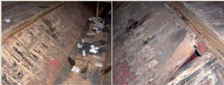
Fig. 1.3 og 1.4: Eksempler på dårligt lastområde (spild, paller, skidt, defekter på anhængerens platform osv.)
