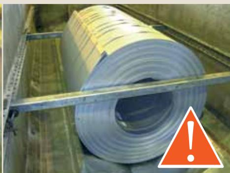
Fig. 1.8 Støttekonstruktion foran og bag coilen uden surringsbånd
