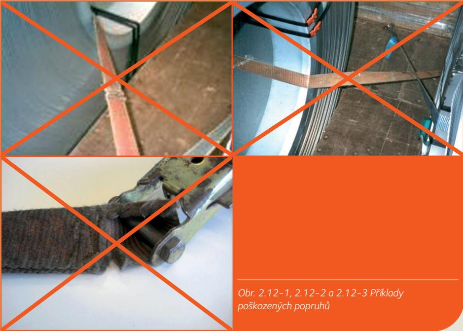
Obr. 2.12-1, 2.12-2 a 2.12-3 Příklady poškozených popruhů
