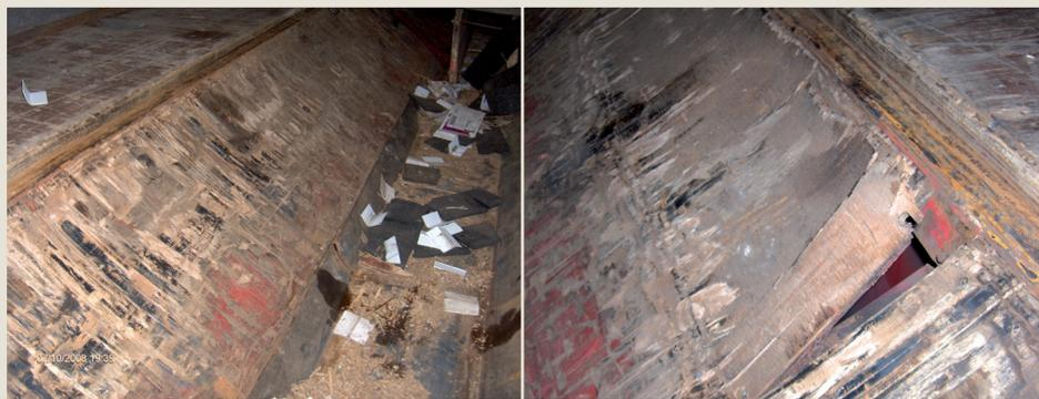
Obr. 1.3 a 1.4: Příklady špatné nakládací plošiny [odpad, palety, nečistoty, poškození krytu přivěsu...]
