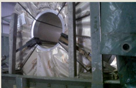
Obr. 1.13: Kostra výměnné nástavby vybavené pro příjem svitků s osou příčně ke směru jízdy; upevnění je provedeno pomocí dvou popruhů a čtyř rohových ochran. Na obě strany je nutné umístit dvojici vzpěr.
