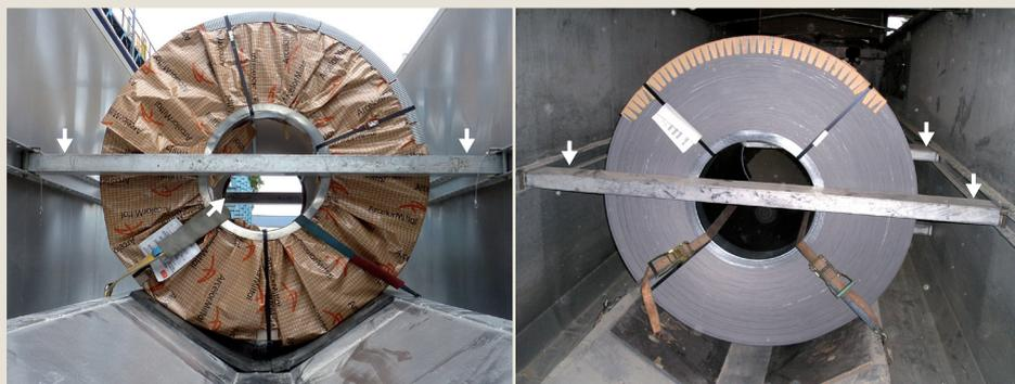
Obr. 1.9 – Nejlépe řešená nosná konstrukce před svítkem a za ním s provazovým upevněním
