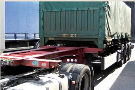
Obrázek 1.12: Výměnná nástavba umístěná na přívěsu
