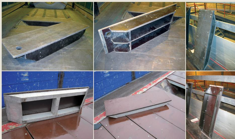
Obr. 2.09-1, 2.09-2, 2.09-3, 2.09-4, 2.09-5, 2.09-6 Příkladů doporučených typů krytů drážek, pokud jsou použity k zachování vzdálenosti
