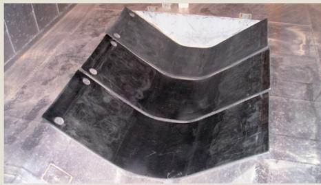
Obr. 2.20 Protiskluzové podložky v nákladním vozu
