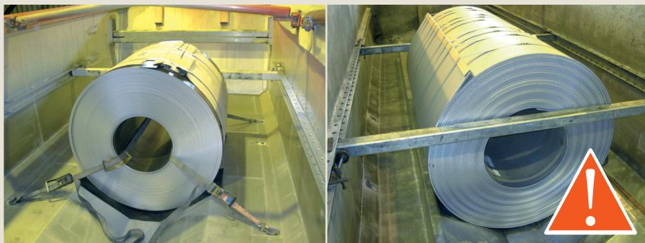
Obr. 1.7 Nosná konstrukce před svitkem s provazovým upevněním
