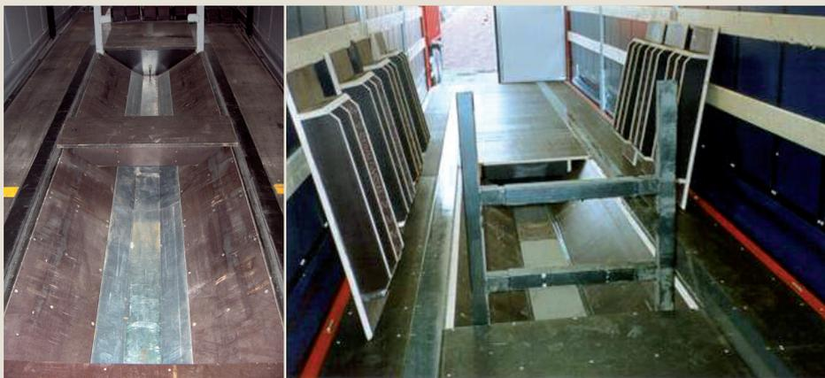
Obr. 1.1 a 1.2 – Fotografie rozvržení běžného přívěsu vybaveného drážkami a nosnou konstrukcí
