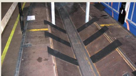
Obr. 2.19 protiskluzová podložka v „běžném“ přívěsu s drážkami
